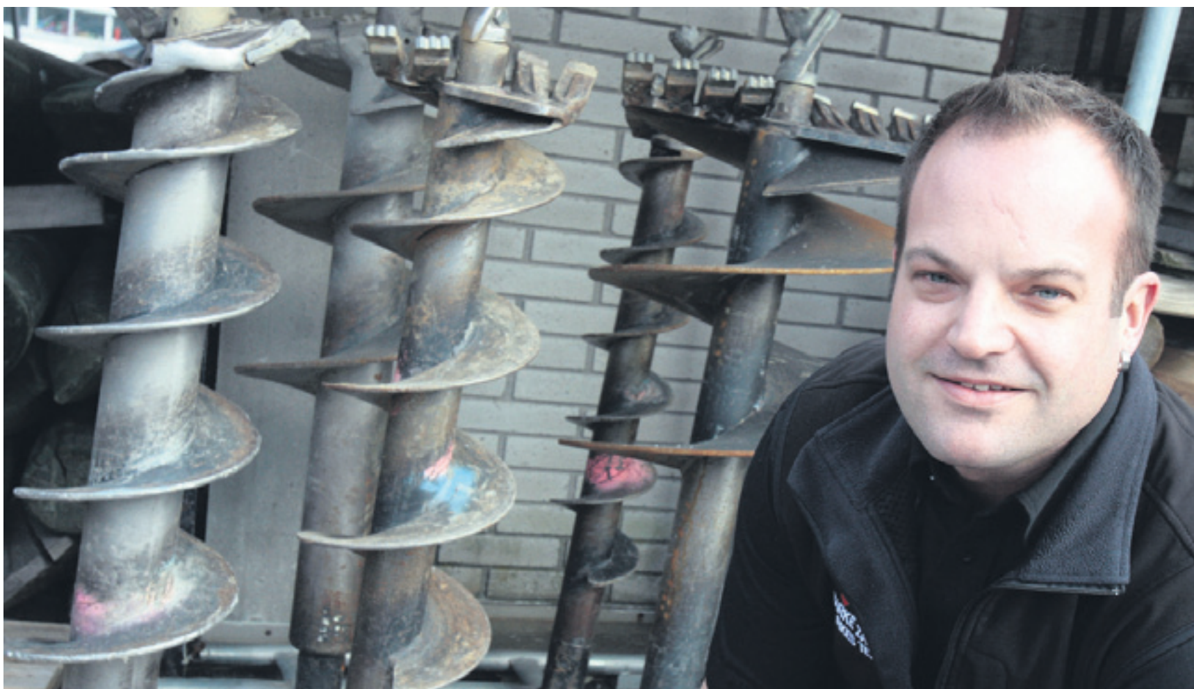
Bohren statt Schaufeln: Mit diesem schweren Gerät bohrt Andreas Hardegger die Löcher, in denen er seine Zäune fest im Boden verankert.
