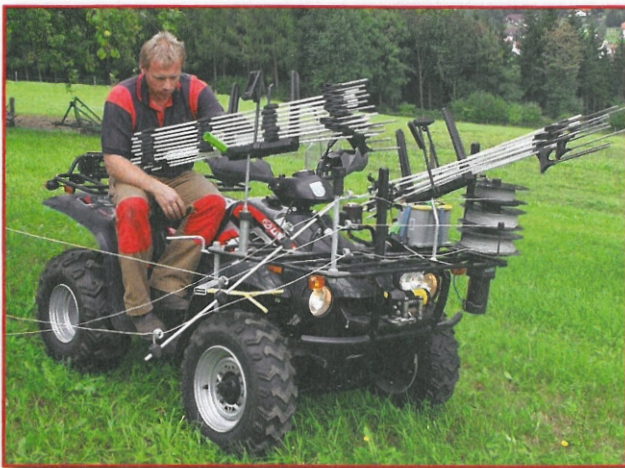
Walter Hübscher: Quad-Einsatz zum Zäunesetzen
