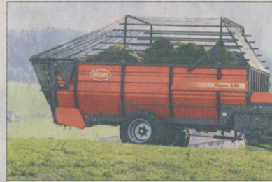
AlpeX der Tiefgänger mit einer Höhe von nur 1.99 m gilt als 28 m³ mit hydr. Kratzboden und hydr. Heckklappe.
