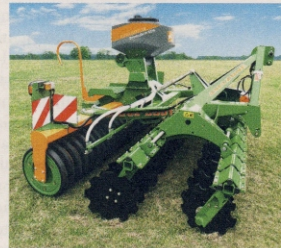
Die Säeinheit Green Drill kann auf verschiedene Amazone-Bodenbearbeitungsmaschinen bis 4 m Arbeitsbreite aufgebaut werden. Werkfoto
