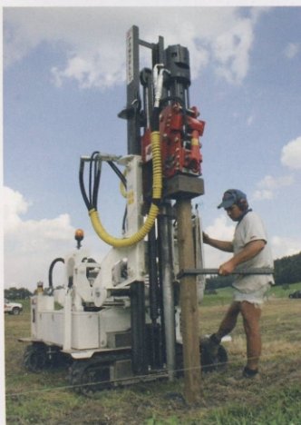
Ramm-Maschine in Aktion
